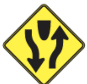
Comienzo de Carretera Dividida
