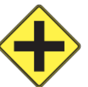
Intersección en 4 Sentidos
