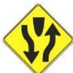
Inicio de camino dividido
